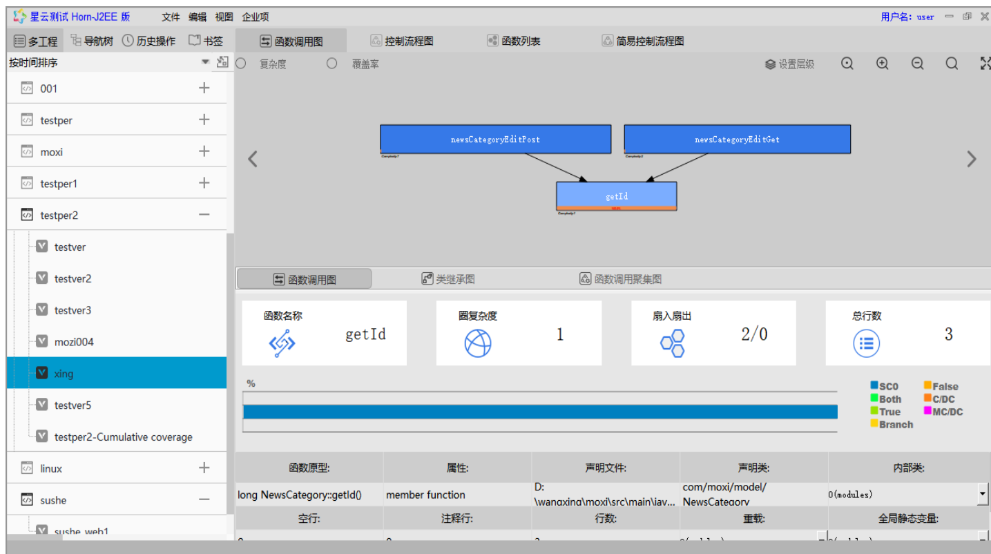
图 4.2.2-1 源码静态结构与动态测试数据统一图（函数调用图）
